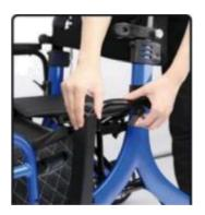
Legen Sie dann den Joystick auf die Armlehne. Entfernen Sie dazu zuerst die Feststellschraube und bewegen Sie dann den Joystick in die gewünschte Position.
